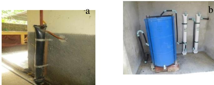
**Figura 6.** Filtro con limallas de hierro sumergidas en agua (a) y Filtro con solución alcalina seguido de filtros en serie con limallas sumergidas en agua (b).
